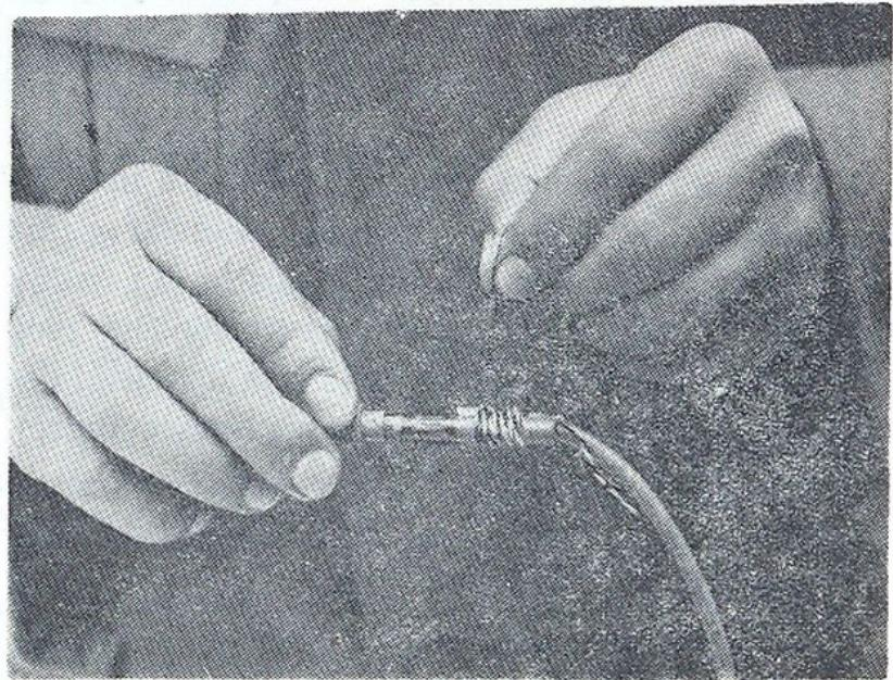
b) Vezivanje detonirajućeg štapina za inicijalni deo
